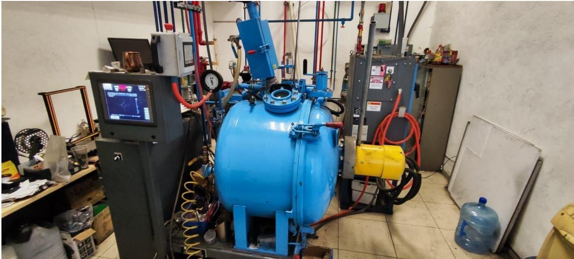
**Figura 14.** Horno de inducción al vacío
