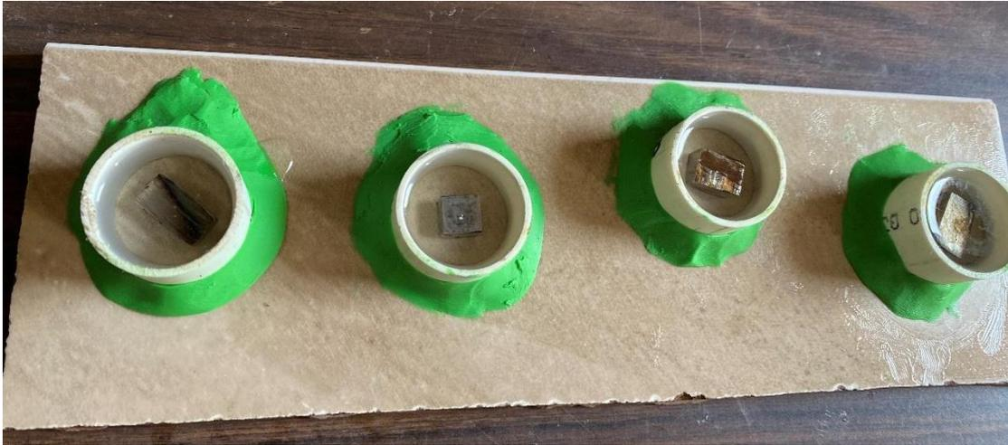
**Figura 20** Posicionamiento de muestras dentro de recipientes y colocación de resina
