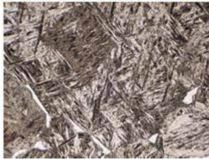
**Figura 6** Microestructura de la bainita
