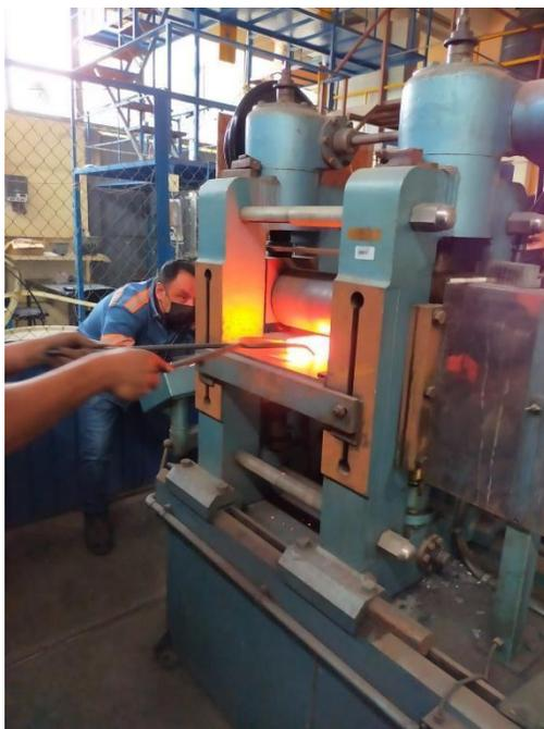
**Figura 17** Laminado de lingote
