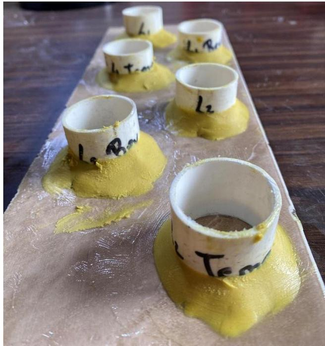
**Figura 19** Colocación de plastilina alrededor del recipiente para sellar y evitar fugas de resina.
