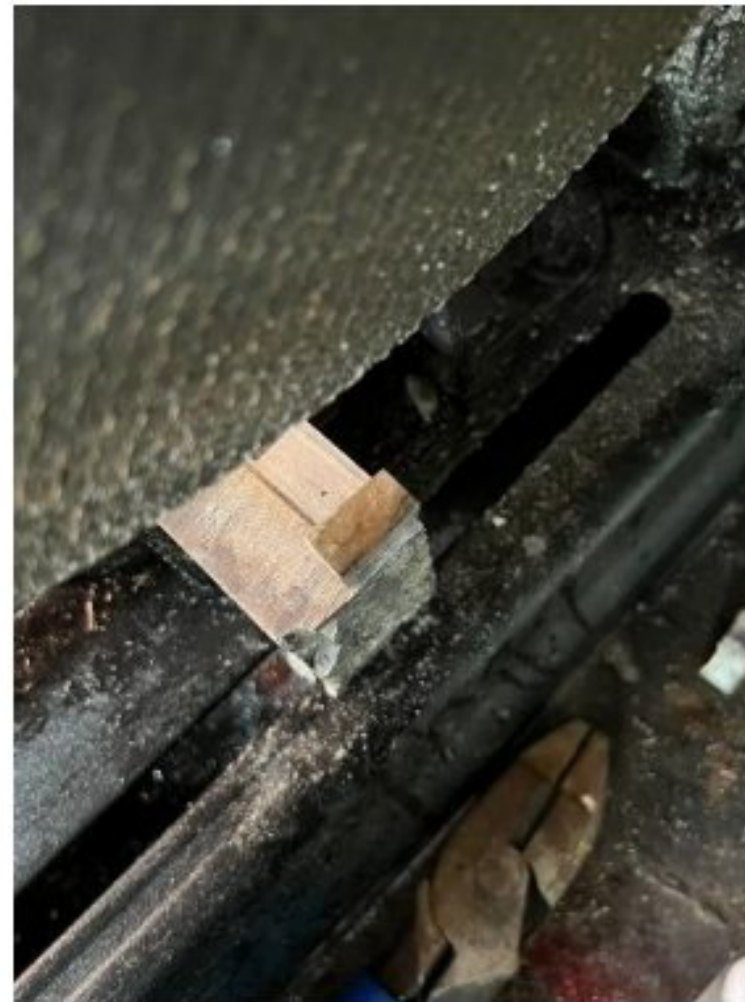
Figura 1 Lingote de aleación Bi 4% llegada para muestra 1x1
