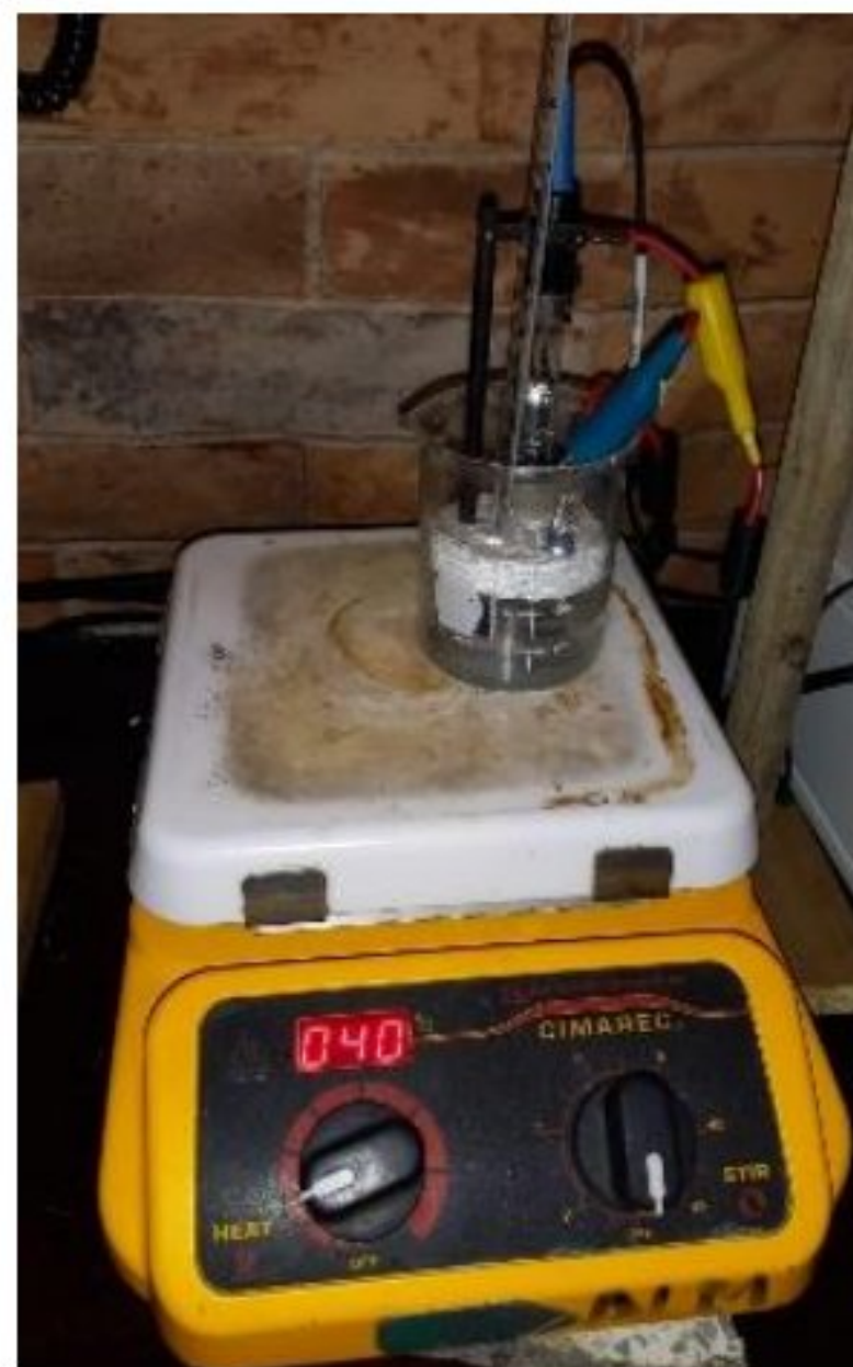
Figura 5 Disposición de la celda electroquímica para la prueba de impedancia para aleación de
