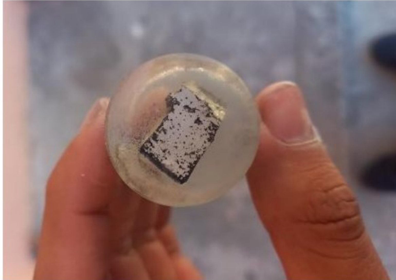
Figura 2 Muestra de aleación 4% de llegada encapsulado
