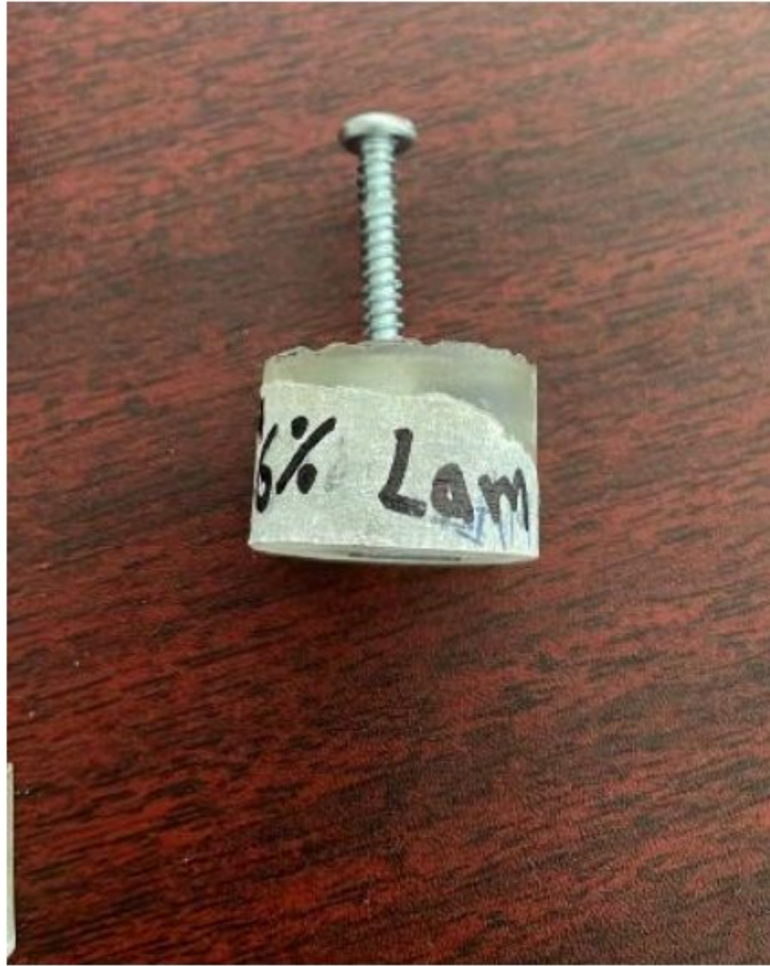
Figura 3 Muestra encapsulada con tornillo para probar la continuidad de corriente
