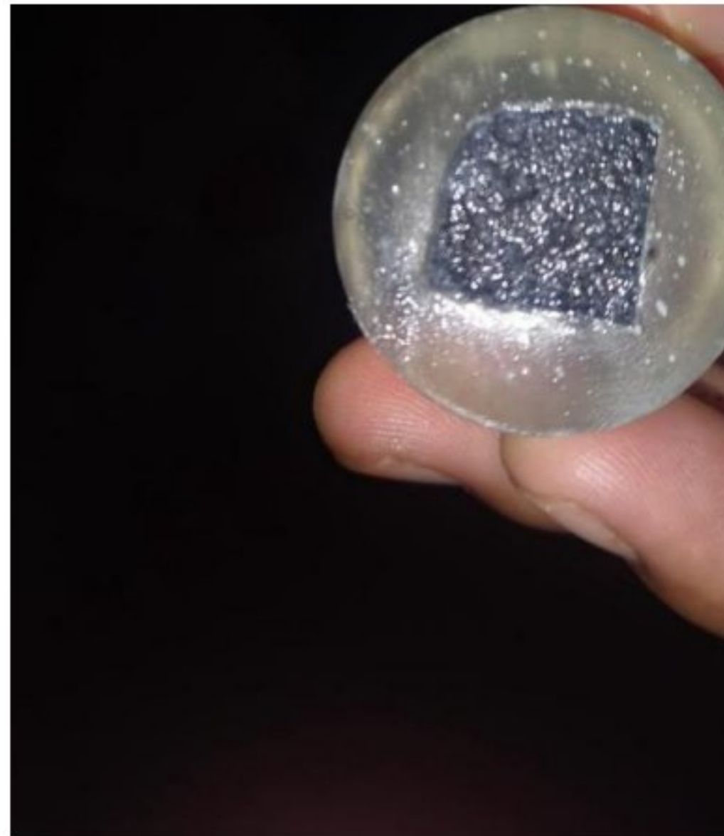
Figura 6 Superficie de la muestra después de la prueba de impedancia de 4hrs
