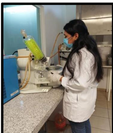
**Figura 8.** Destilación con rotavapor
