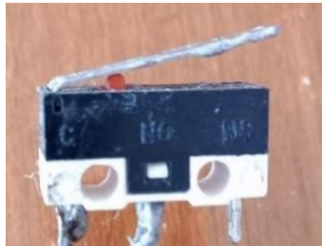
Figura 80: Micro Switch empleado en el proyecto. Fuente: Elaboración Propia 2024
