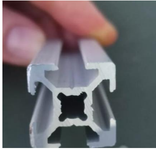
Figura 27: Perfil de Extrusión de modelo "6105-t5" Fuente: Elaboración Propia 2024
