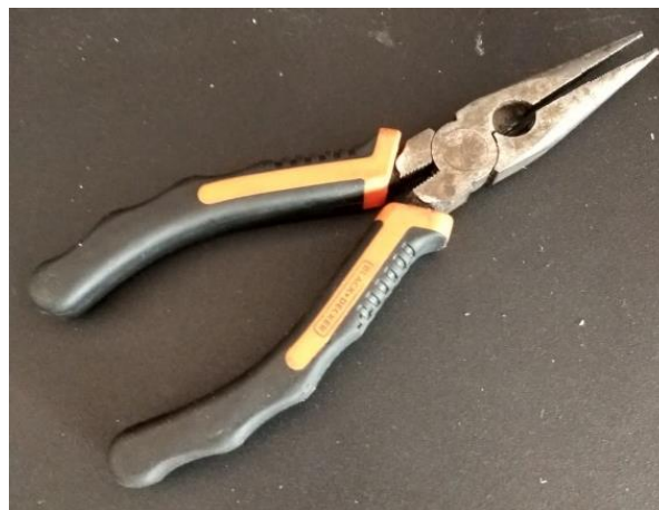
Figura 152: Pinzas de punta empleadas para retirar los soportes de las piezas impresas en 3D. Fuente: Elaboración Propia 2024.
