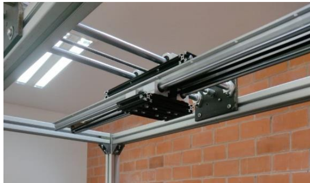
Figura 53: Armazón y estructura del Módulo de Monitoreo con su respectivo riel Fuente: Elaboración Propia 2024
