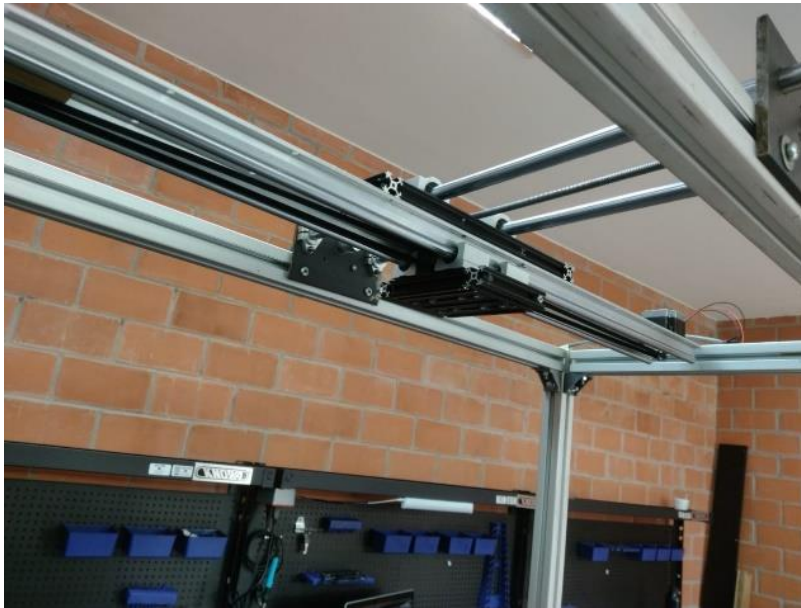
Figura 37: Ensamble y acoplamiento de las placas cortadas de aluminio a la estructura del Modulo de Monitoreo. Fuente: Elaboración Propia 2024
