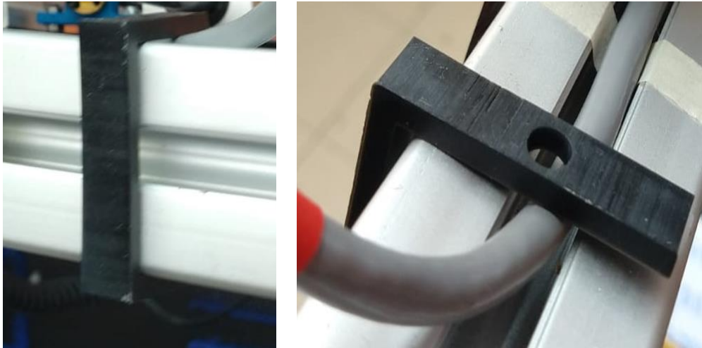
Figura 167: Soporte-Grapa en forma de “U” para la Fijación del Cableado, “Acoplado”. Fuente: Elaboración Propia 2024.
