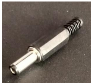
Figura 51: Conector de Alimentación/2300 “Jack Macho” Fuente: Elaboración Propia 2024
