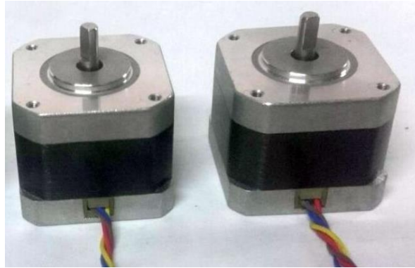
Figura 54: Motores a pasos o “passo a passo” Modelo Nema-17. Fuente: Elaboración Propia 2024.
