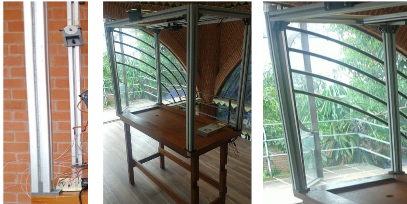
Figura 32: Estructura ya Acoplada y Armada de la Estructura para el Módulo de Monitoreo. Fuente: Elaboración Propia 2024
