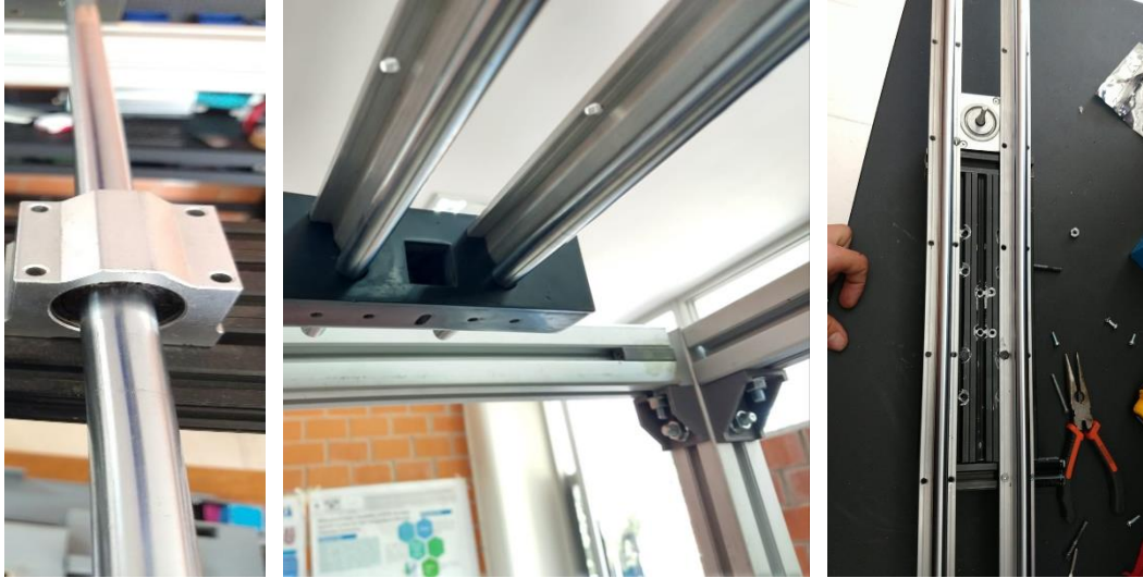
Figura 34: Montaje de los rieles y Tornillo sin Fin para la movilidad del Módulo de Monitoreo. Fuente: Elaboración Propia 2024
