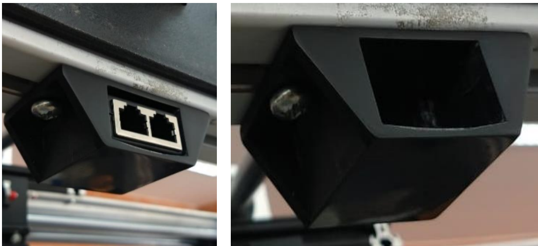
Figura 168: Soporte-Cople en forma de Pirámide para interconectar el cable RJ45, “Acoplado”. Fuente: Elaboración Propia 2024.
