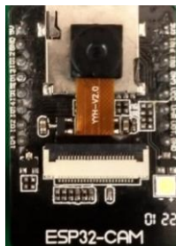
Figura 100: Microcontrolador Esp32 Cam. Fuente: Elaboración Propia 2024
