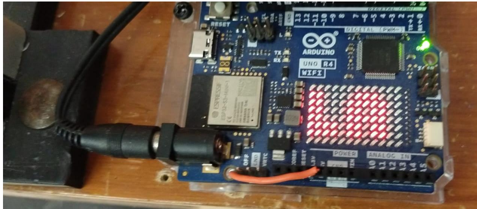
Figura 126: Microcontrolador Arduino UNO R4 Wifi “Encendido”. Fuente: Elaboración Propia 2024.
