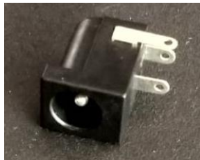
Figura 50: Conector de Alimentación/2300 “Jack Hembra” Fuente: Elaboración Propia 2024
