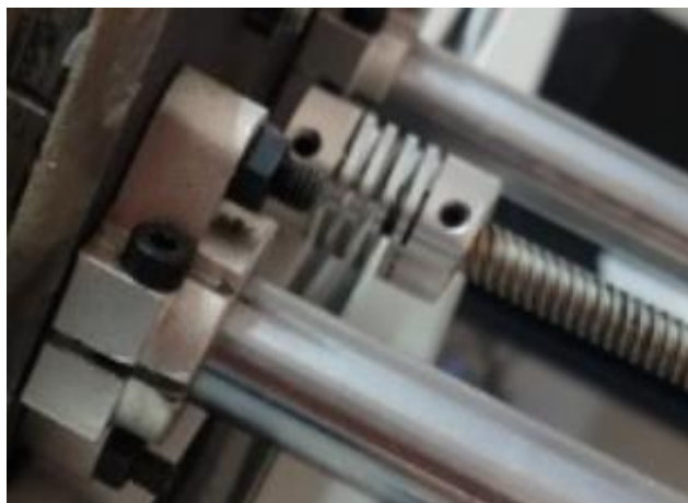
Figura 79: Cambio del Resorte en el tornillo sin Fin Fuente: Elaboración Propia 2024
