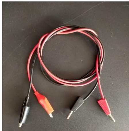
Figura 42. Cables de tipo Banana-Caiman, conectados a la salida de la fuente y a un conductor. Fuente: Elaboración Propia.
