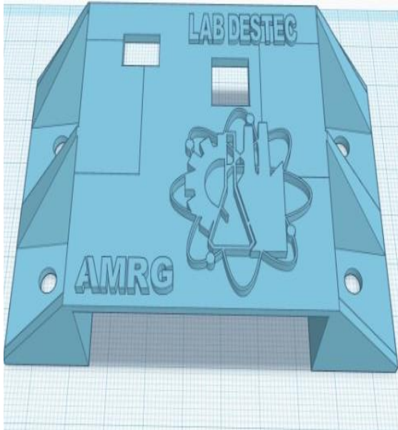
Figura 176: Tapa Principal para la Inserción del Microcontrolador Esp32 Cam. Fuente: Elaboración Propia 2024.
