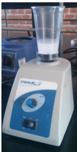
Figura 3.9. Mezcla colocada en el agitador de vórtice.
