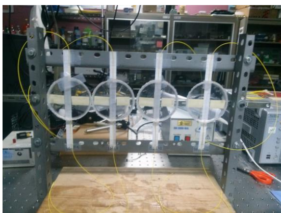
Figura 3.12. a) Con ayuda de la jeringa se vacía la mezcla en el molde, b) Membranas vaciadas.
