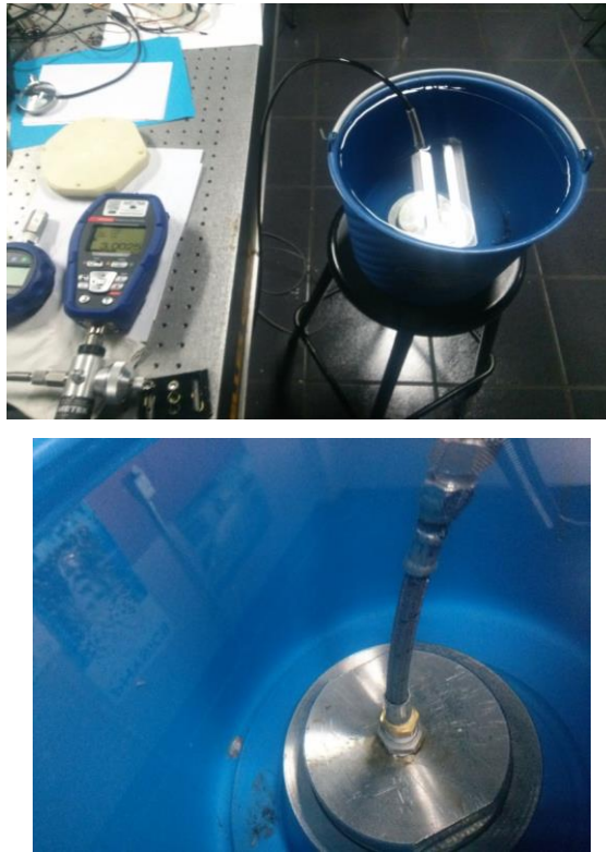
Figura 3.34 Prueba de fugas.
