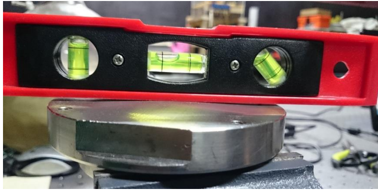
Figura 4.30 Tapa del sensor deformada.
