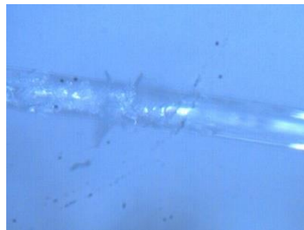
Figura 3.21 Fibra SMS fracturada.
