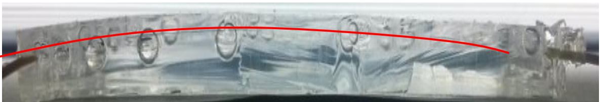
Figura 3.19 Fibra F10 deformada por curvatura.
