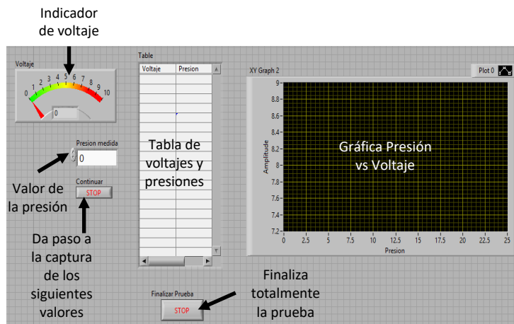
Figura 3.39 Panel frontal del programa de obtención del voltaje.
