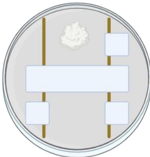
**Figura 8.** Ensamble de la cámara de incubación para micro cultivo.
