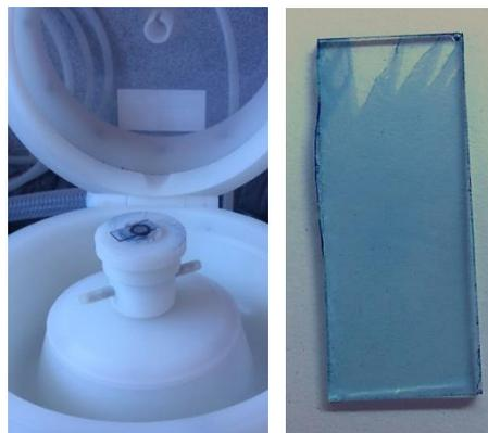
*Figura 2.4.2. Depósito spin-coating de las películas de PANI disuelta en NMP.*
