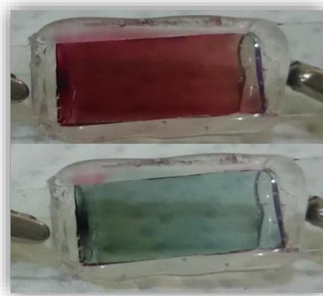
Figura 2.6.2.3. Dispositivo electrocrómico dual (DED), VIDRIO-ITO/PANI-BQ/PE/P3HTr-SC/ITO-VIDRIO 1.4 V (color rojo) y -1.4 V (color azul).
