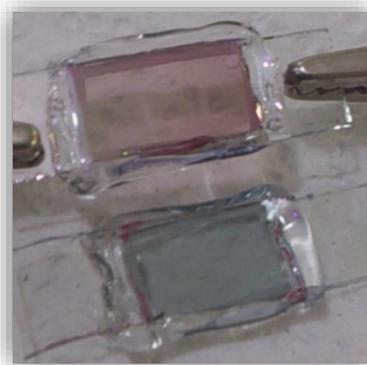
Figura 2.6.1.3. Dispositivo electrocrómico simple (DES), VIDRIO-ITO/PE/P3HTTr-SC/ITO-VIDRIO 1.4 V (color rojo) y -1.4 V (color azul).
