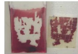
*Figura 3.5.1. Gráficas de las pruebas de adherencia según la norma ASTM 3359 de las películas de: a) PANI-BQ, b) PANI-SC, c) NTSPA-PANI-BQ, d) NTSPA-PANI-SC, e) P3HTr-SC, f) P3HTr-DC, g) P3HT-SC y b) P3HT-DC.*
