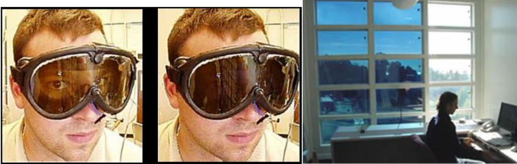
*Figura 1.8.1. a) Dispositivo electrocrómico de transmisión variable integrado en un sistema de visión desarrollado por los grupos del Pr. G.A. Sotzing (Institute of Materials Science, UCONN) y Pr. T.F. Otero (Centro de Electroquímica y Materiales Inteligentes, UPCT) b) Ventana inteligente desarrollada por la compañía Smartglass.*
