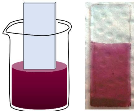
*Figura 2.4.4. a) Depósito dip-coating (DC) de las películas de los poli-(3-hexiltiofenos), b) película P3HTr-DC.*
