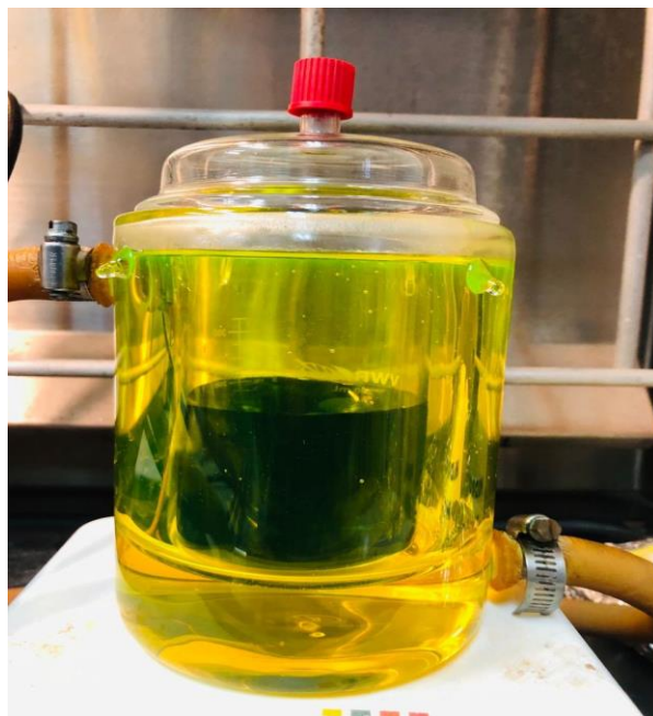
Figura 17. Síntesis del óxido de cobre mediante la técnica de baño químico
