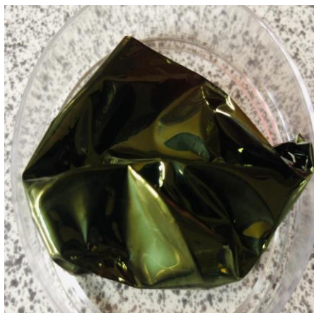
Figura 25. Película obtenida del P3HT
