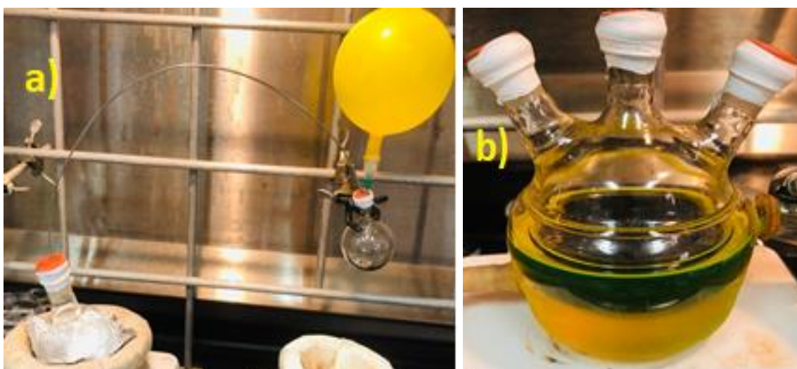
Figura 26. a) método utilizado para depositar la mezcla que contiene las nanohojuelas de CuO a la mezcla que contiene el monómero 3HT, b) Síntesis in-situ a 0^\circ\text{C} durante 24 h
