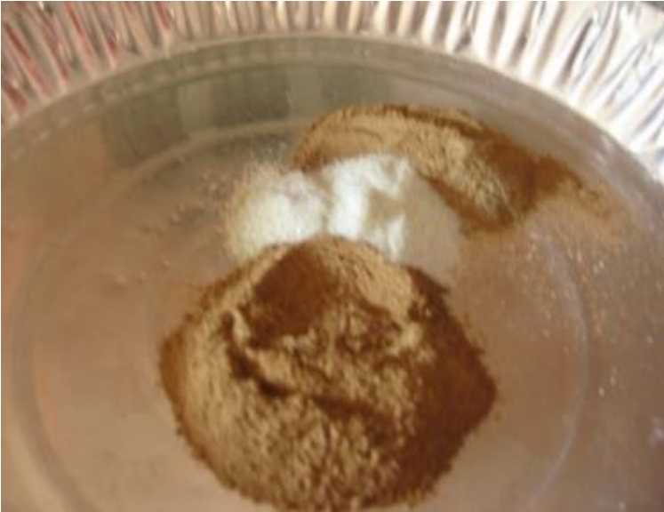
Arcilla, vidrio y tezontle molido para realizar la mezcla.
