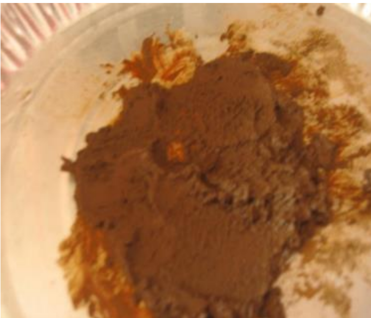
Mezcla de arcilla, vidrio, tezontle molido y agua.
