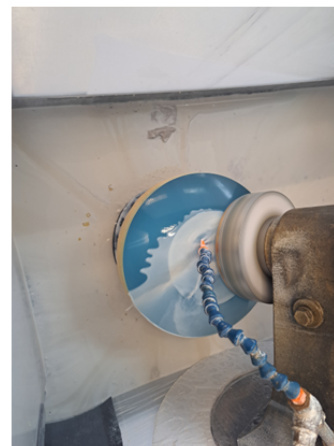
Figura 3.12: A) técnica de generación de curvaturas, B) generación de la curvatura.
