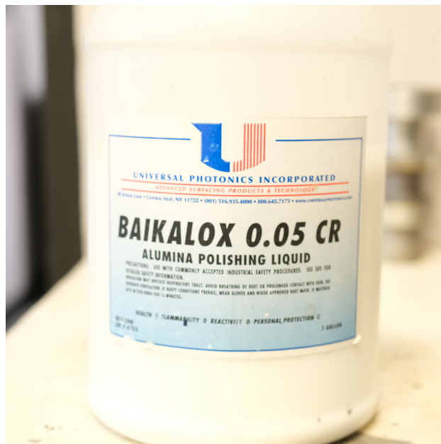
Figura 3.9: Compuesto de pulido de óxido de aluminio.
