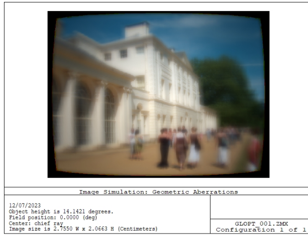
Figura 3.21: Análisis de imágenes del diseño óptico.
