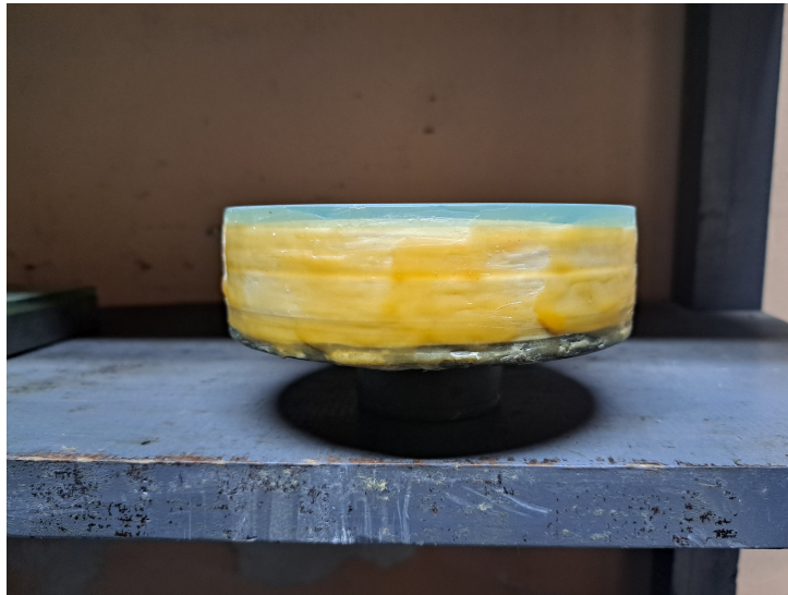
Figura 3.11: encapsulado del bloque de vidrio.
