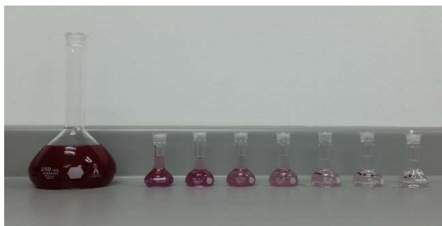
Figura 9 Soluciones utilizadas en la curva de calibración del RD 82
