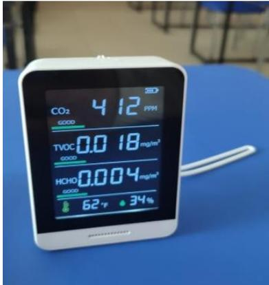
**Figura 25.** Monitor de calidad del aire en interiores.
