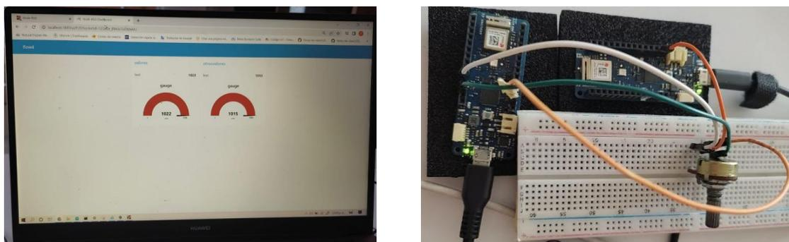
**Figura 30.** Pruebas de conexión entre Arduino MKR WIFI 1010 y Node-red.
