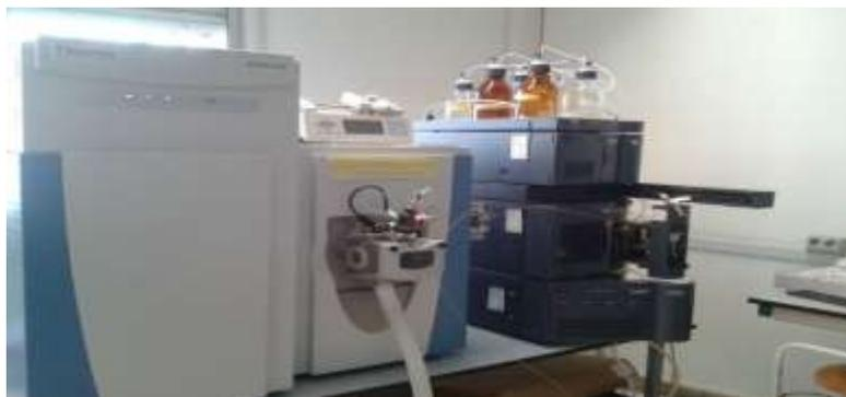
**Figura 11.** Equipo Orbitrap-cuadrupolo híbrido conectado a un espectrómetro de masas de alta resolución Q Exactive.
