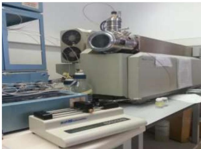
**Figura 18.** Optimización de las condiciones EM-EM en el equipo 4000QTRAP
