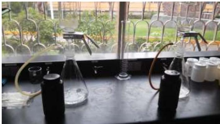
**Figura 13.** Sistema de filtración a vacío
