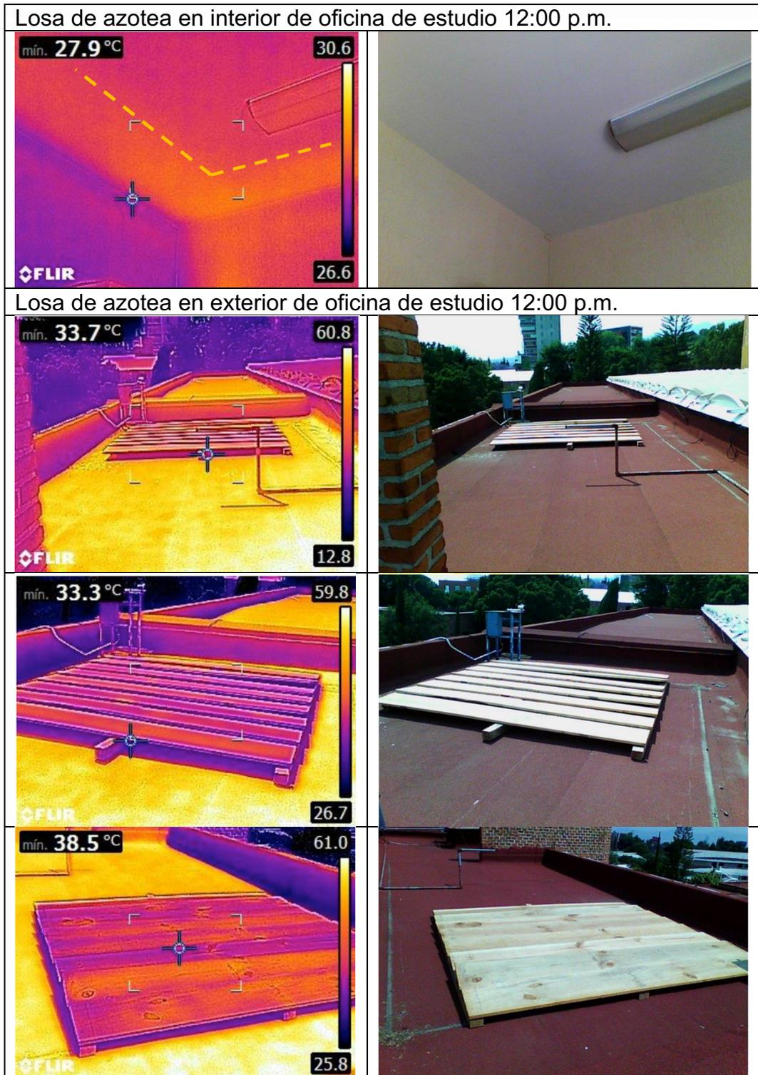
**Figura 22.** Reporte fotográfico tomado con cámara termográfica en muro sur y losa de azotea de oficina analizada con tratamiento de techo doble y su transferencia de calor hacia oficina inferior.
