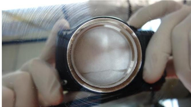
Figura 4.3. Malla de cobre electroformado para homogeneizar el campo eléctrico entre los electrodos.
