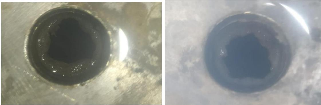
Figura 4.1 Incrustación en la entrada del tubo del intercambiador de calor.
