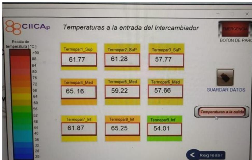
Figura 4.2. Temperaturas a la entrada del intercambiador de calor.
