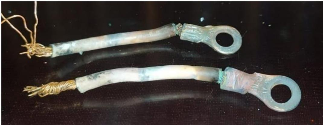
Figura 3.1 Estado de conexiones eléctricas en el intercambiador de calor.
