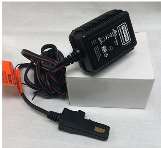
Figura 3.3 Transformador clase 2, Fuente.
