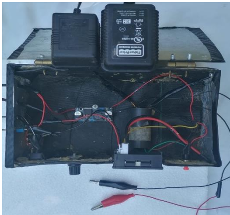
Figura 4.2 Ensamble de componentes de la fuente de alto voltaje
