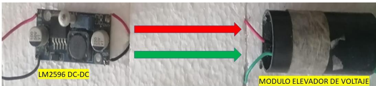
Figura 3.8 Conexión del regulador (LM2596 DC-DC).
