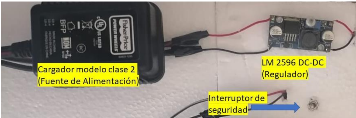
Figura 3.7 Conexión de la fuente de alimentación, interruptor, LM 2596 DC-DC.
