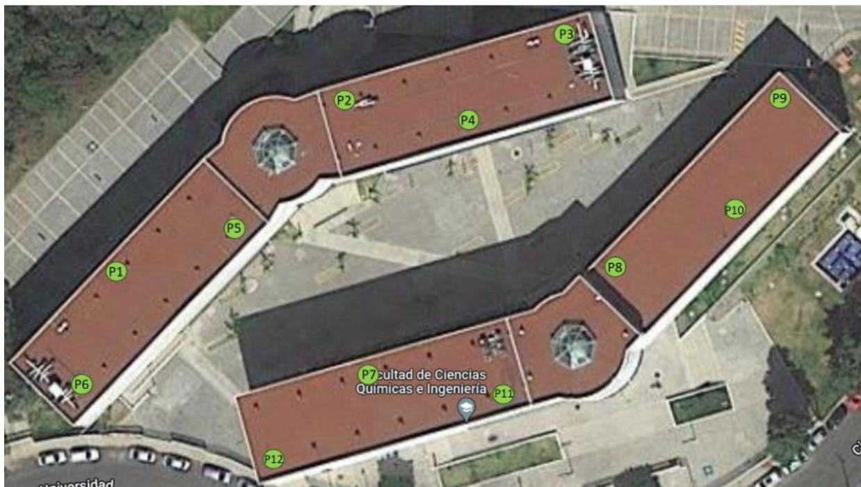
Ilustración 11: Ubicación de los pararrayos por medio de una imagen satelital obtenida de Google Maps
