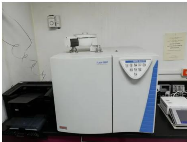
Figura 14. Equipo de análisis elemental orgánico FLASH 2000 de Thermo Scientific [92].
