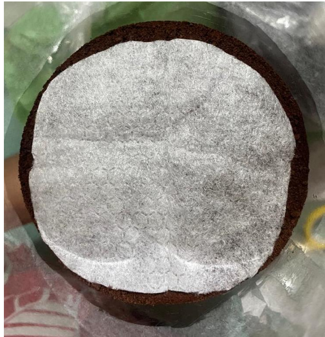
Figura 35. Tela de algodón utilizada para separar la capa del tezontle de las arenas.
