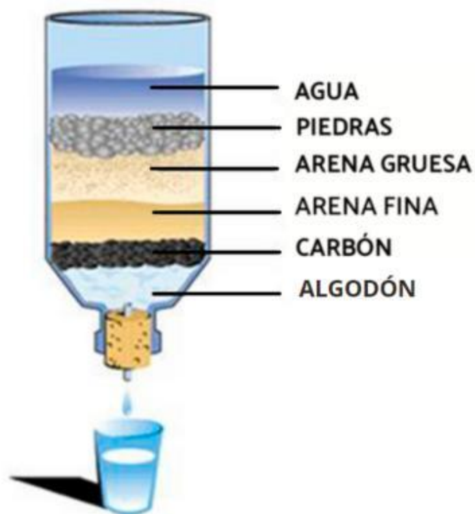
Figura 8. Filtro casero de Agua compuesto por diversas capas [68].
