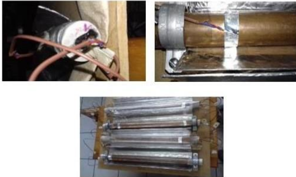
Figura 3.4. (A) Colocación de termopares en tubo colector, (B) Termopar en la parte exterior del tubo, (C) Montaje de CPC en laboratorio.
