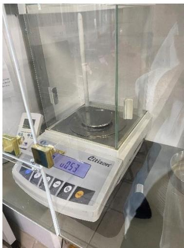
**Figura 8. Balanza microanalítica CX265.**
