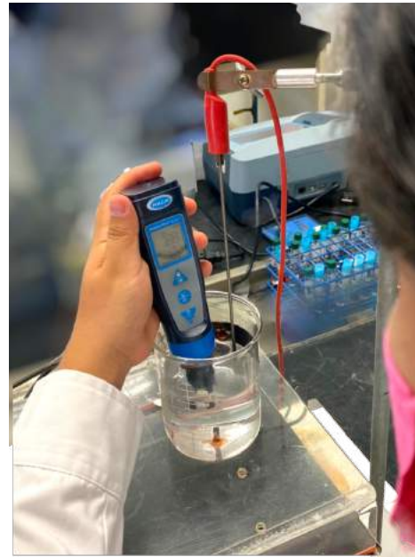
Figura 17. Medición de variables con multiparámetro HACH
