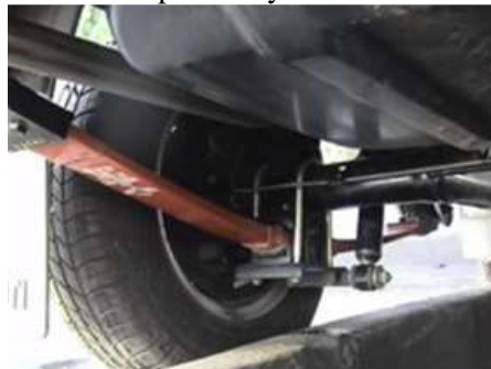
Imagen 4. Sistema de suspensión y muelles en vehículos de carga
