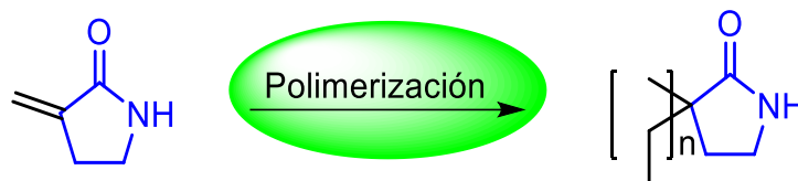
Figura 4. \alpha -metilen- \gamma -lactamas como bloques de construcción de polímeros.
