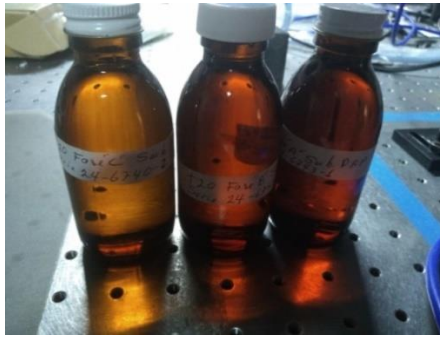
Figura 5.11 Aceites aislantes de muestra de un transformador eléctrico.
