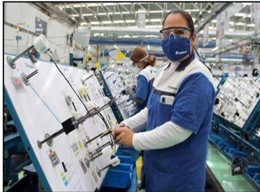
Figura 1 Estación de trabajo del área de tableros para el ensamble del arnés (Fujikura, 2022).
