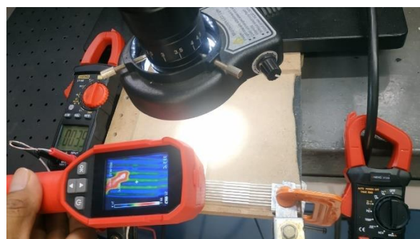
Figura 49 Temperatura en la flecha medido con termopar
