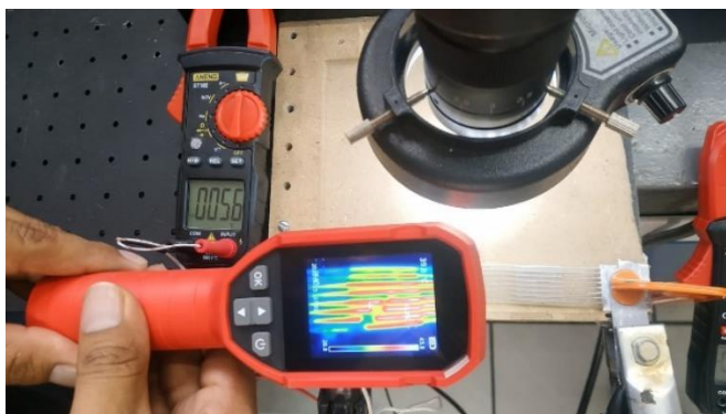
Figura 50 Temperatura en los brazos después de modificar, medido con termopar.
