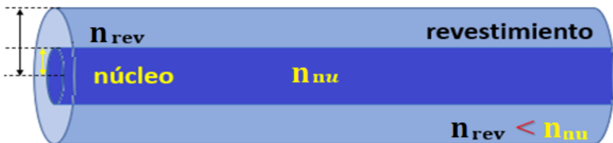
Fig.8. Ilustración de una fibra óptica, n_{nu} y n_{rev} son los índices de refracción del núcleo y del revestimiento respectivamente.
