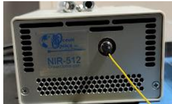
Fig. 70. Fotografía del espectrómetro con longitud de onda 900-1700nm de detección, Ocean Optics.
