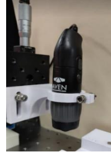
Fig. 68. Fotografías del microscopio óptico de mano para medir la geometría de las fibras ópticas.
