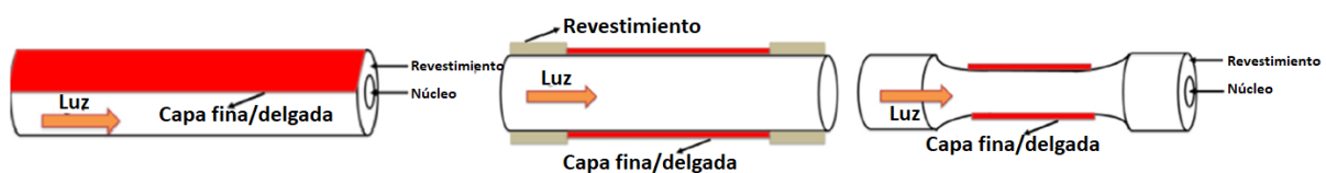
Fig. 62. Esquema general con diferentes formas de fibras ópticas adelgazadas basadas en LMRs [68].
