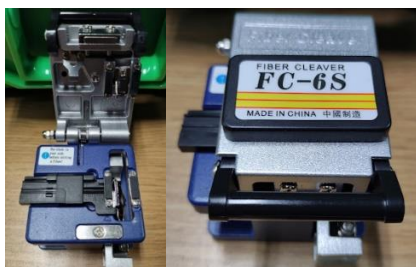
Fig. 65. Fotografías de la estructura interna y externa de la cortadora transversal de fibra óptica Fiber Cleaver.
