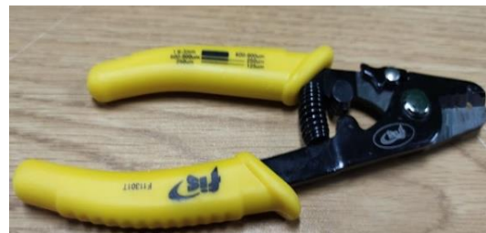
Fig. 64. Fotografía de la pinza removedor de plástico FIS modelo F11301T.
