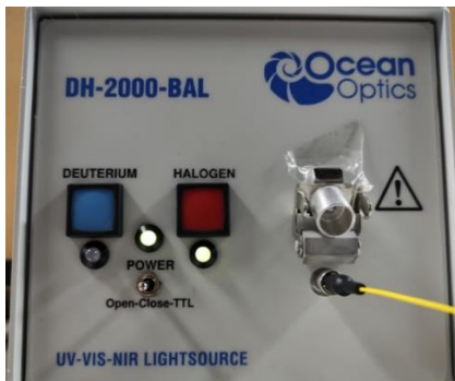
Fig. 69. Fotografía de la fuente de luz con longitud de onda de operación de 200-2000 nm, Ocean Optics.
