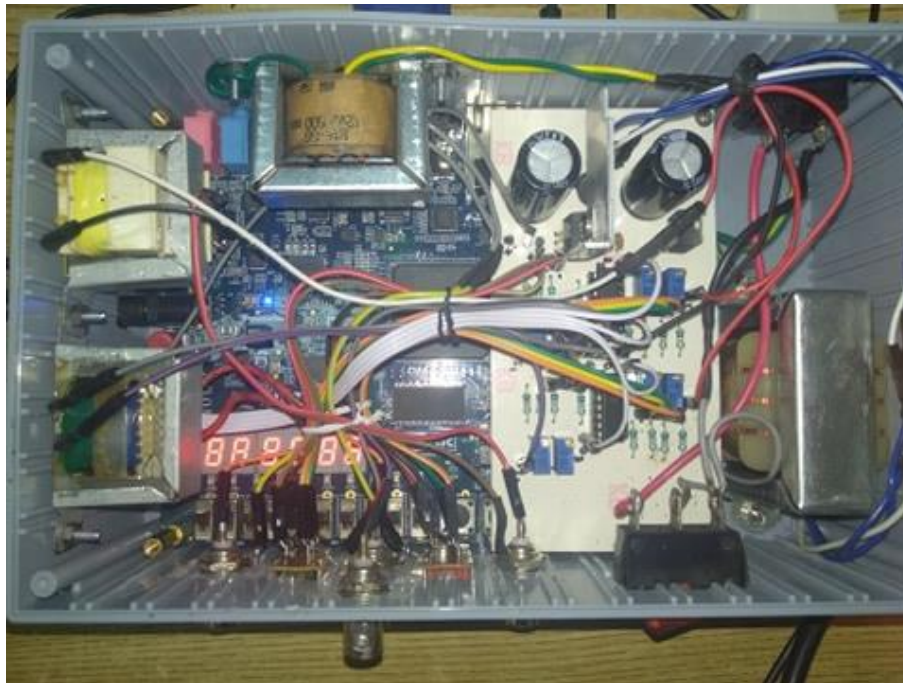
Figura 5.14 Circuito implementado en el gabinete junto con el FPGA y los transformadores de medición.
