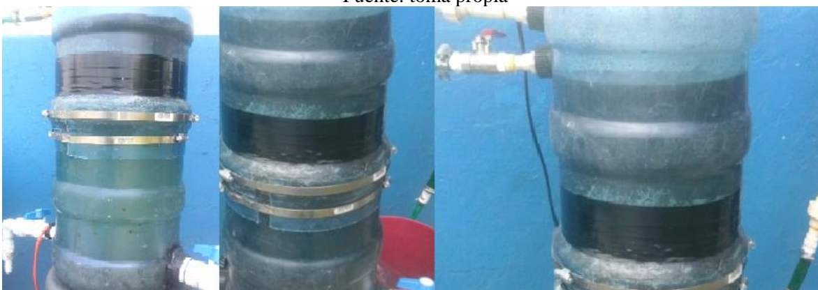
Figura 21. La llave de purga se localiza en la parte inferior izquierda en la imagen izquierda se aprecia una tonalidad más clara de la cual se purgaba parte de esa agua para obtener la concentración de agua deseada; la otra llave de purga se localiza arriba a la izquierda
