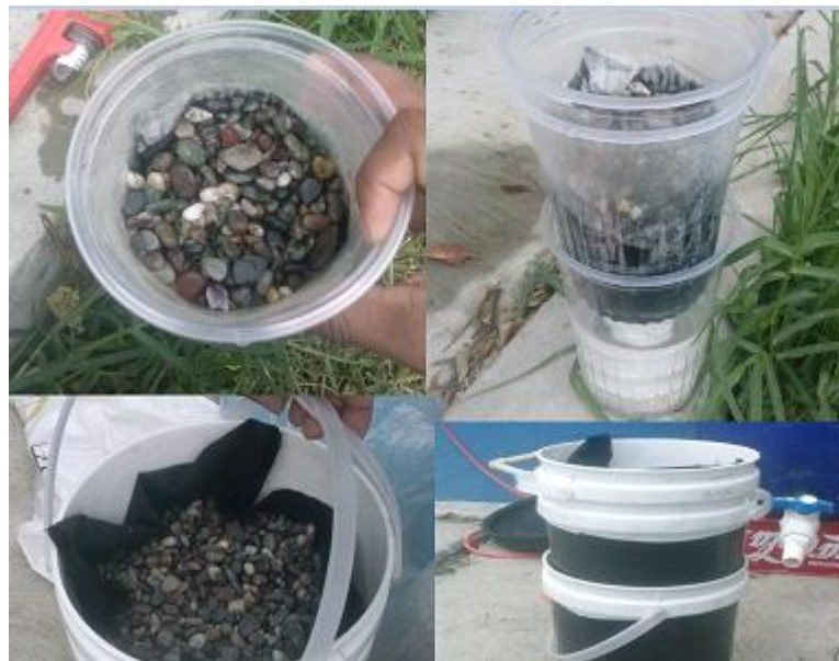
Figura 14. Filtro 2. Filtro aerobio (verde) Filtro de arena de sílice o cuarzo fina (con diámetros de valores entre .0625 a 1 mm aprox.).
