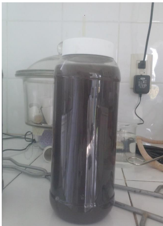
Figura 24. Muestra de lote 2 al final del proceso anaeróbico, donde se puede apreciar que es totalmente homogénea y la presencia de fases es poco diferenciable Fuente: toma propia
