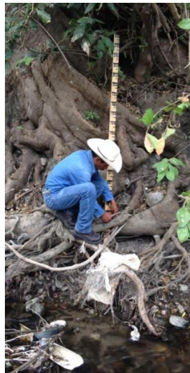
Fig.2- Regla de nivel para medir niveles del río
