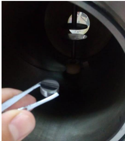
40: Introducción de las piezas con las pinzas
