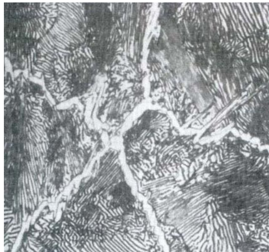
Figura 15: Microestructura de un acero hipereutectoide
