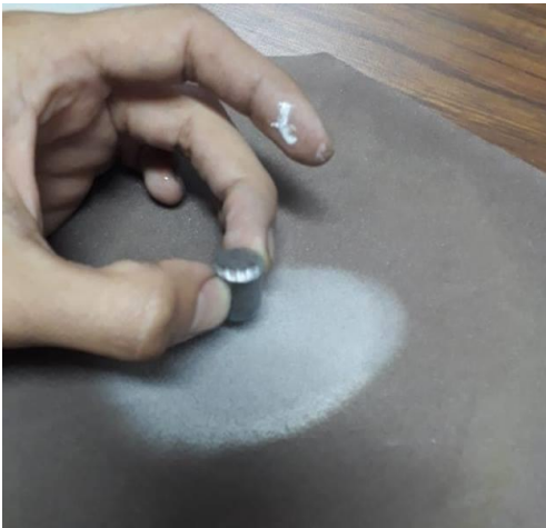
Figura 31: Pulido a espejo con alumina y paño
