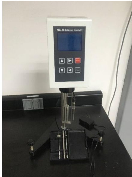
FIGURA 4.6.2.1 VISCOSÍMETRO ROTACIONAL (BAUSCH & LOMB, NDJ-8S ROTATIONAL VISCOMETER)
