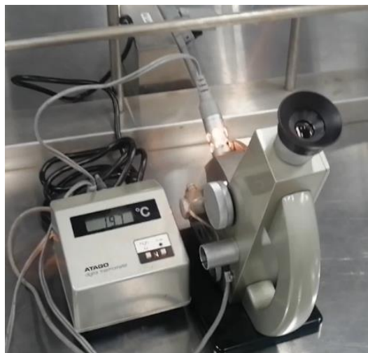
FIGURA 4.6.3.1 REFRACTÓMETRO (ATAGO NAR-T3)
