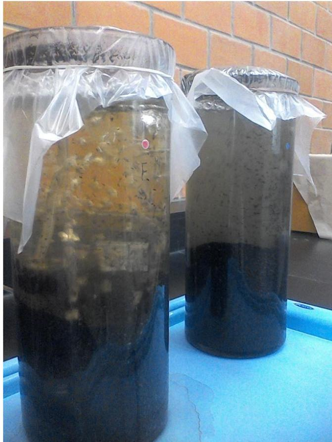
**A3.3** Visualización de la operación de los reactores A y B tras cerca de 40 horas de remoción de DQO. Se puede apreciar que el reactor A (lado izquierdo) una mejor clarificación del agua residual debido a un mejor desempeño de remoción de DQO debido a eficiencias mejores de remoción en comparación del reactor B (lado derecho).
