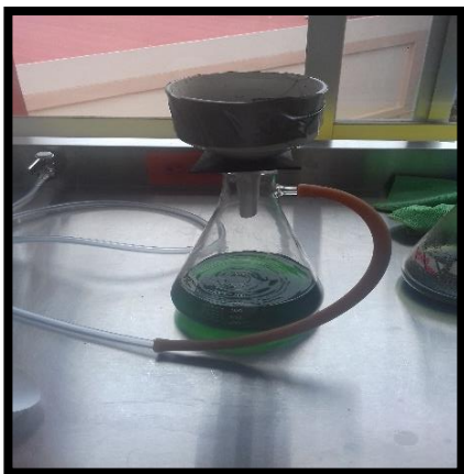
Fig.7. Bomba de vacío. Filtración del extracto crudo
