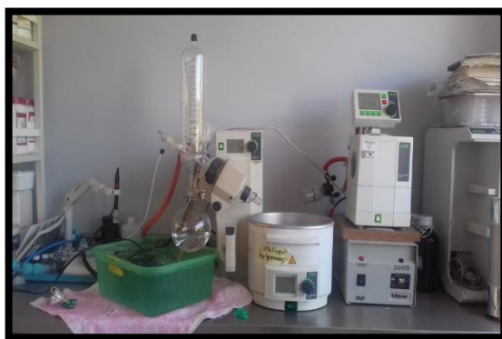
Fig.8. Rotaevaporador. Concentración de extracto crudo
