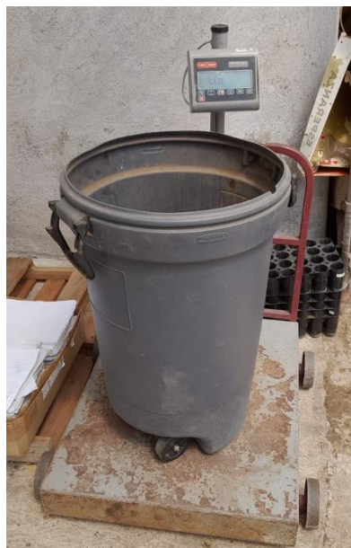
Figura 10. Contenedor utilizado para cálculo del peso volumétrico
