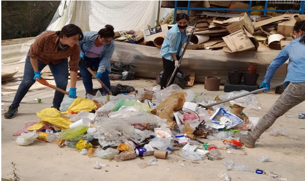
Figura 8. Homogenización de la muestra para la cuantificación de subproductos.
