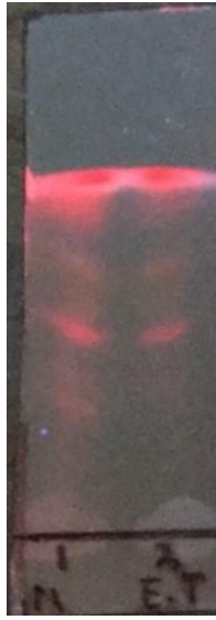
Figura 32. Placa CCF fase normal 1. EMMm; 2. EMEt 95:05 diclorometano/metanol, expuesta a luz UV de onda larga (365 nm)
