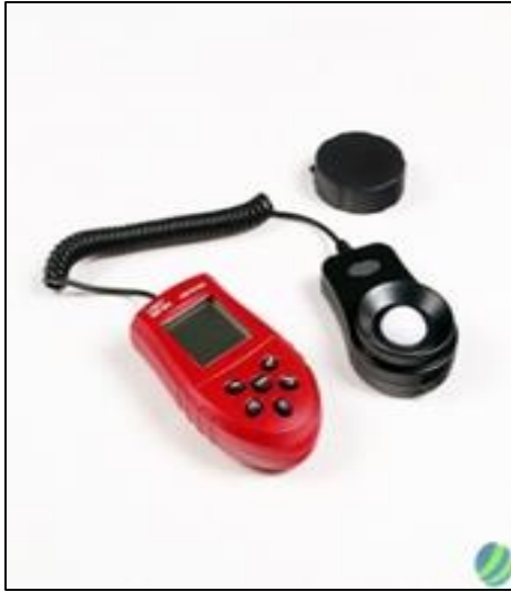
Figura 3.13 Dispositivos para medir el flujo luminoso. (Mazola N,2019).
