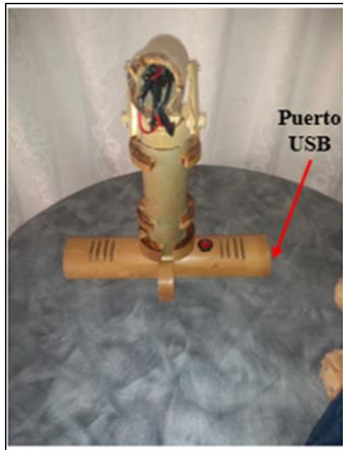
Figura 3.11. Ubicación del puerto de conexión
