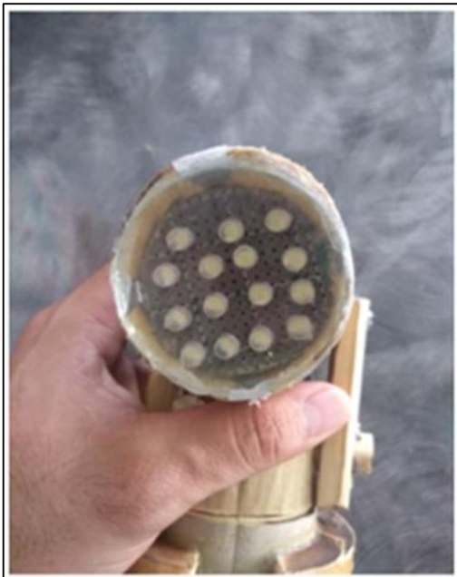
Figura 3.9. Ensamble del circuito de leds en el porta bombilla.
