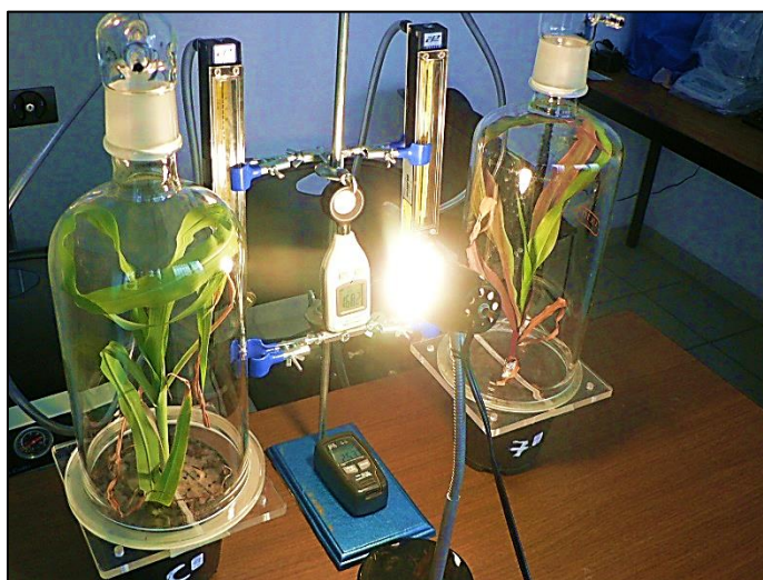
Figura 3. Sistema de aireación dinámica abierta para la extracción de volátiles de maíz Cuarenteño y Asgrow A7573.
