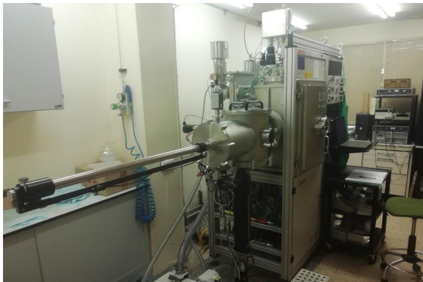
Figura 19. Equipo de pulverización catódica
