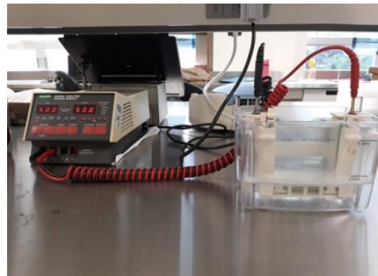
FIG. 8. Electroforesis (SDS-PAGE) 12%, para la identificación proteica de los venenos S. viridis Say y S. polymorpha . (López, 2019)
