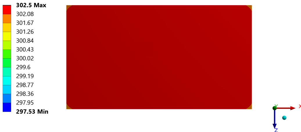
Figura 5.19: Contorno de temperatura de operación de la capa activa de la DSCs en agosto a las 8 horas con h=5.82 , Mérida, Yucatán.
