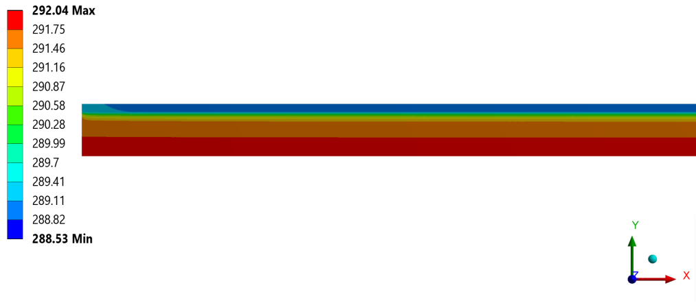
Figura 5.26: Contorno de temperatura de operación en el plano medio del modelo DSCs en enero a las 8 horas con h=5.82 , Mérida, Yucatán.
