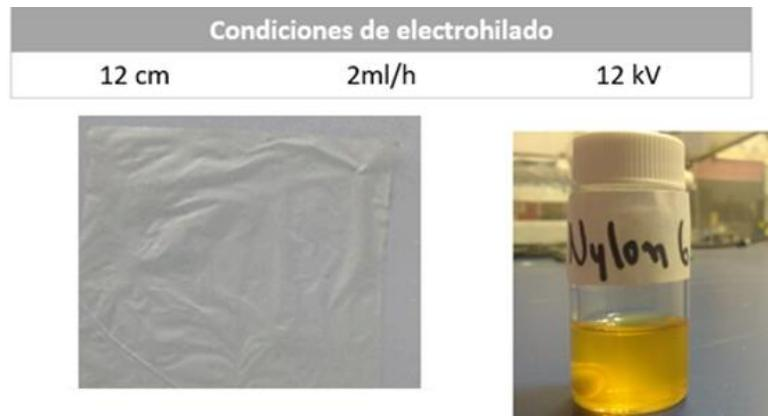
Figura 37 Condiciones de electrohilado para nylon 6,6.
