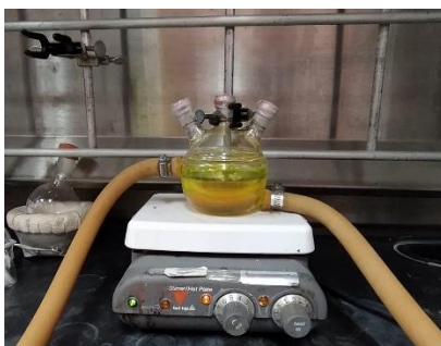
Figura 2.2.1.1 Síntesis in-situ de P3HT con AgNPs
