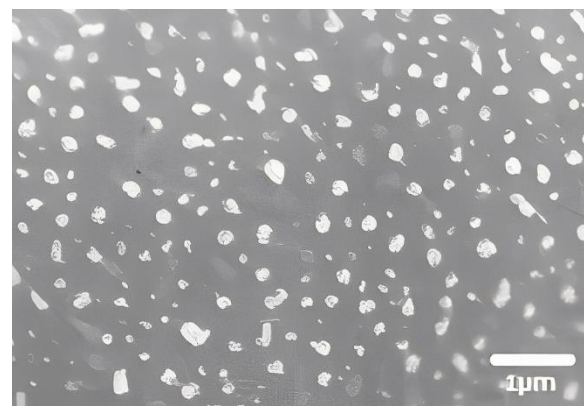
Figura 3.3.2 Mapeo del compuesto P3HT – AgNPs al 8% wt maximizado 10 veces
