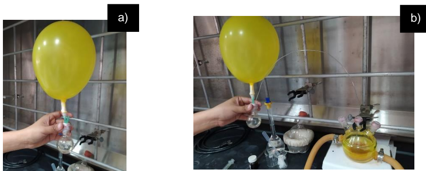
Figura 2.1.2.2 a) Matraz que contiene la solución monómero/ CHCl_3 y globo con nitrógeno que ayudara al goteo de la solución a través de la cánula; b) Sistema de goteo.
