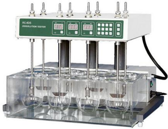
Figura 14. Equipo de laboratorio. A la izquierda equipo de disolución y a la derecha canastillas para la muestra. (Equipoparalaboratorio.com, 2022)
