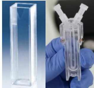
Figura 10. Material de laboratorio. En la izquierda celda de plástico con la que se puede determinar tamaño de gota y del lado derecho celda especial para medir potencial Zeta DTS1070. (Malvern, 2022)
