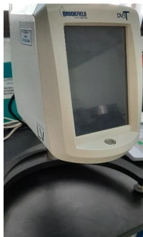
Figura 11. A la izquierda equipo de laboratorio viscosímetro Brookfield DV3T y a la derecha aguja #62 especial para este equipo.
