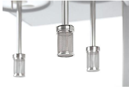
Figura 14. Equipo de laboratorio. A la izquierda equipo de disolución y a la derecha canastillas para la muestra. (Equipoparalaboratorio.com, 2022)
