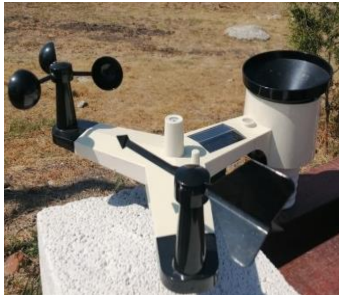
Figura 6 Estación meteorológica. a) Estación meteorológica para medir la radiación solar y la temperatura ambiente.
