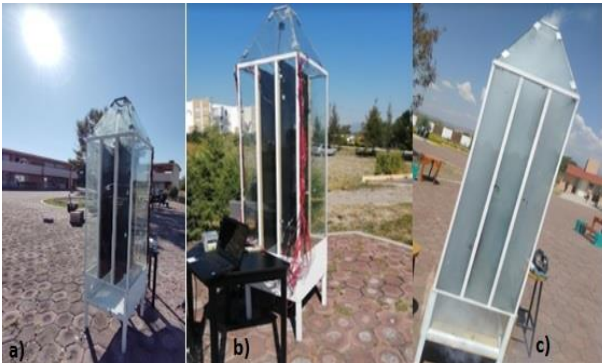
Figura 12 Chimenea solar experimental. a) Modelo experimental, b) Instrumentación electrónica y c) Funcionamiento de la chimenea solar.
