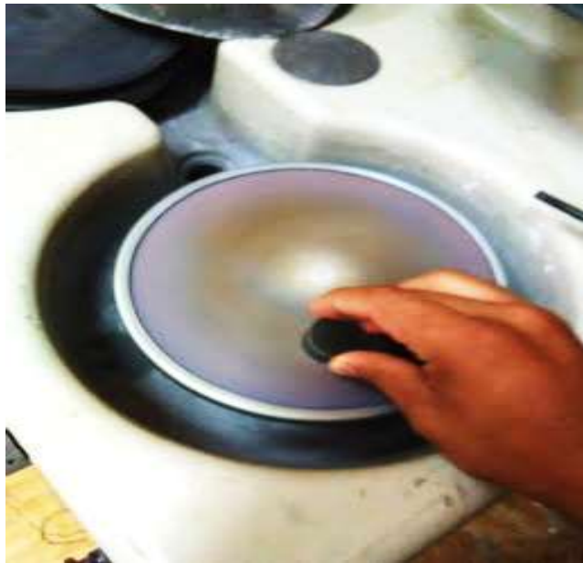
Figura 22. Pulido de muestra en disco rotatorio, con paño de billar
