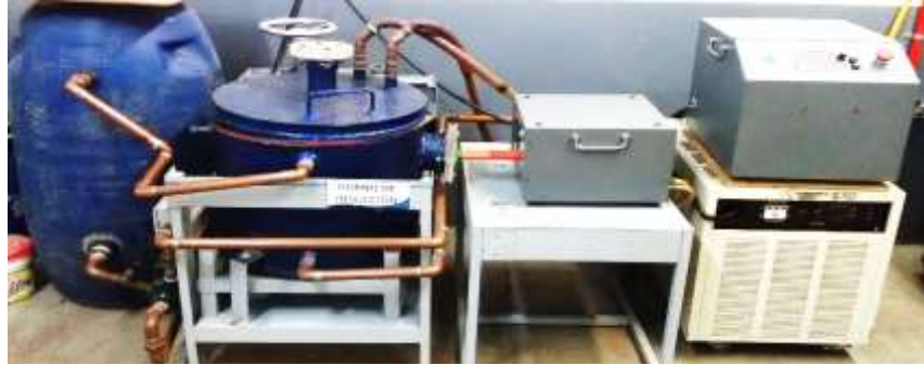
Figura 9. Sistema de fundición por inducción. Fuente (TAMULBA)
