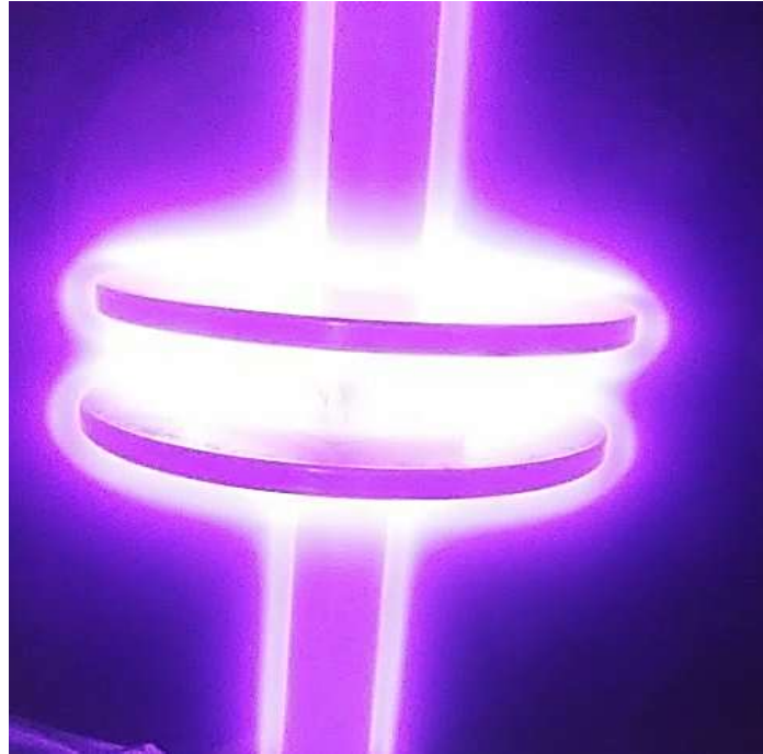
Figura 39. Se muestra la pieza de la aleación binaria ( \text{Ni}_3\text{Fe} ) en el proceso nitruración por plasma.
