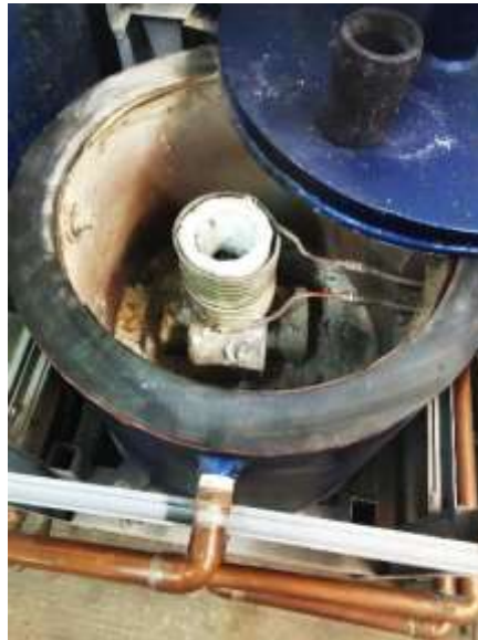
Figura 10. Bobina que se encuentra dentro del horno donde se realiza la fundición debido a la presencia del campo magnético
