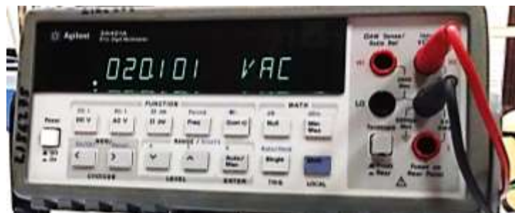
Figura 36. Muestra el medidor de voltaje marca Agilent (Modelo 344401A) con intervalos de 0-700 V y 1 A
