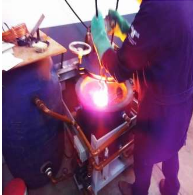
Figura 13. Extracción del crisol con la mezcla (Ni, Fe) del horno
