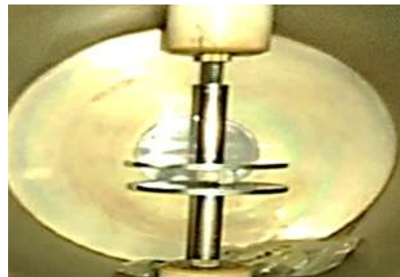
Figura 31. Interior de la cámara donde se encuentran los electrodos de acero inoxidable
