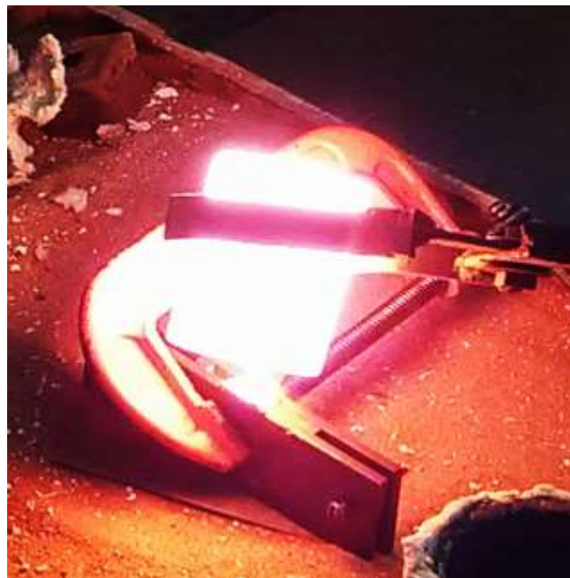
Figura 14. Vaciado de la mezcla líquida en el molde
