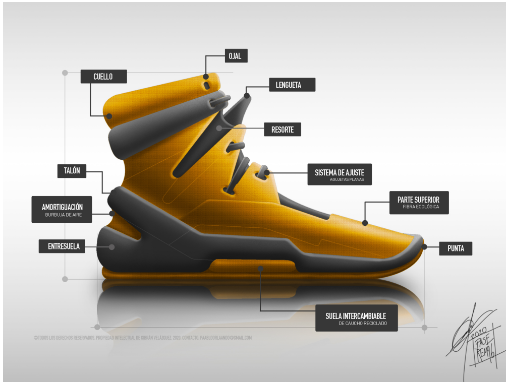
Figura 2.4 Principales elementos del calzado deportivo 2 Fuente: Gráfico de elaboración propia, 2020.
