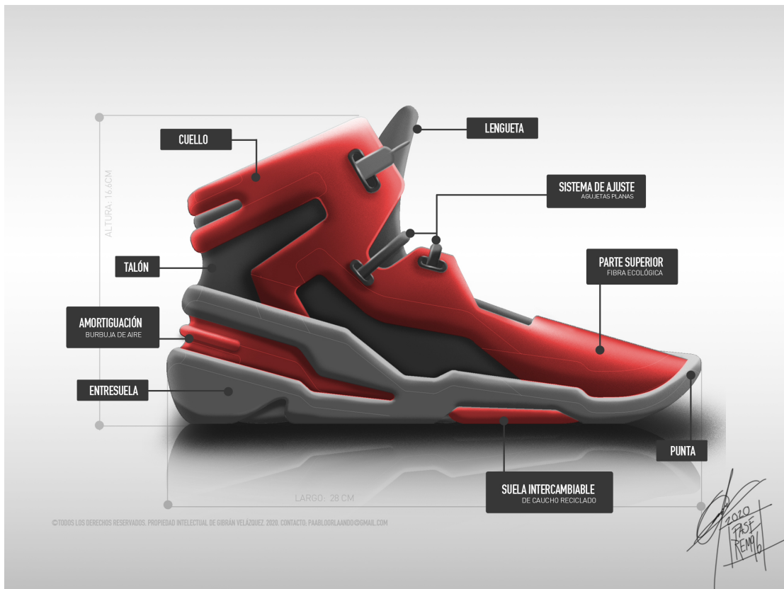
Figura 2.5 Principales elementos del calzado deportivo 3 Fuente: Gráfico de elaboración propia, 2020.
