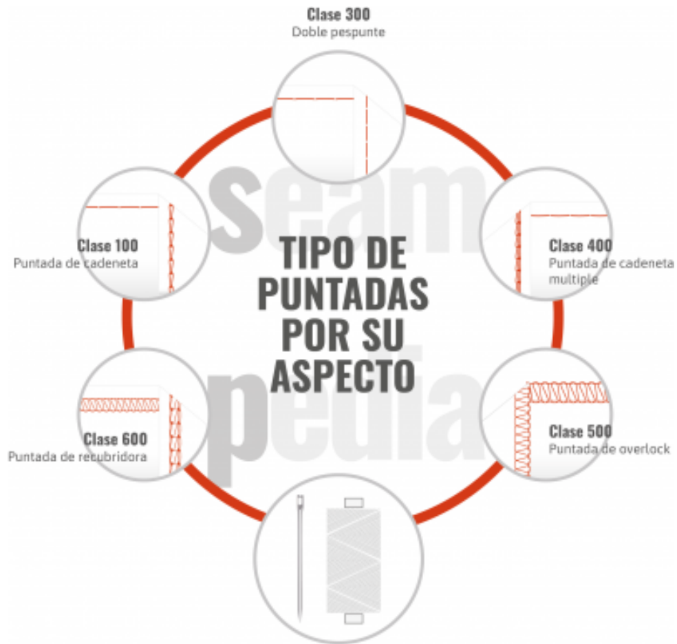
Figura 2.7 Tipo de puntadas por su aspecto Fuente: Clasificación de costura. Según el tipo de puntada. (Seampedia, 2019)
