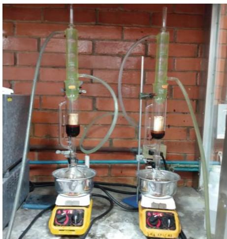
Figura 2.5: Equipo Soxhlet para la extracción del bioaceite.
