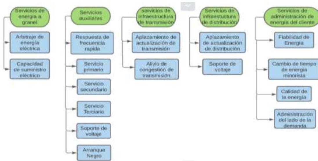
Figura 6 Servicios de los sistemas de almacenamiento y su relevancia en la integración de fuentes renovables variables [25].
